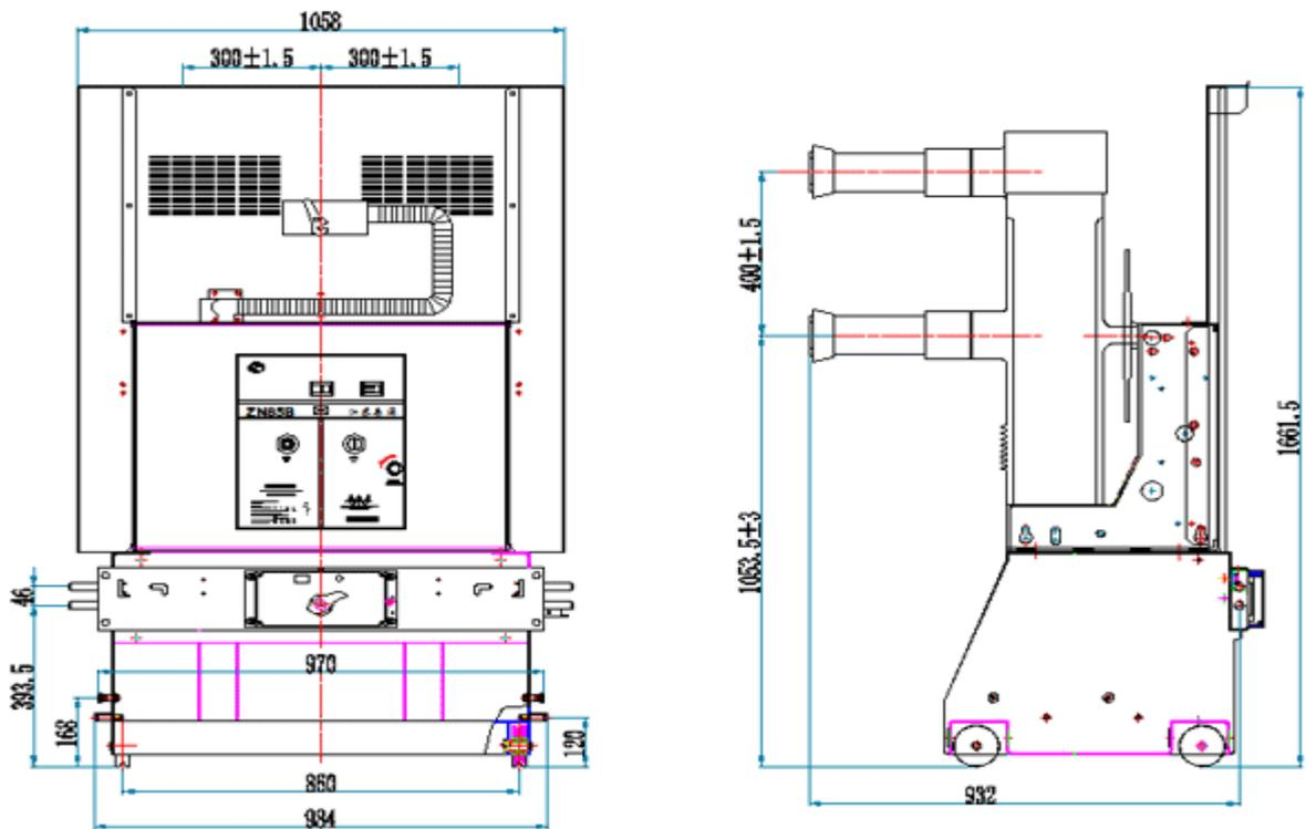
ZN85B-40.5高压真空断路器手车外形尺寸（配KYN61B型开关柜）
