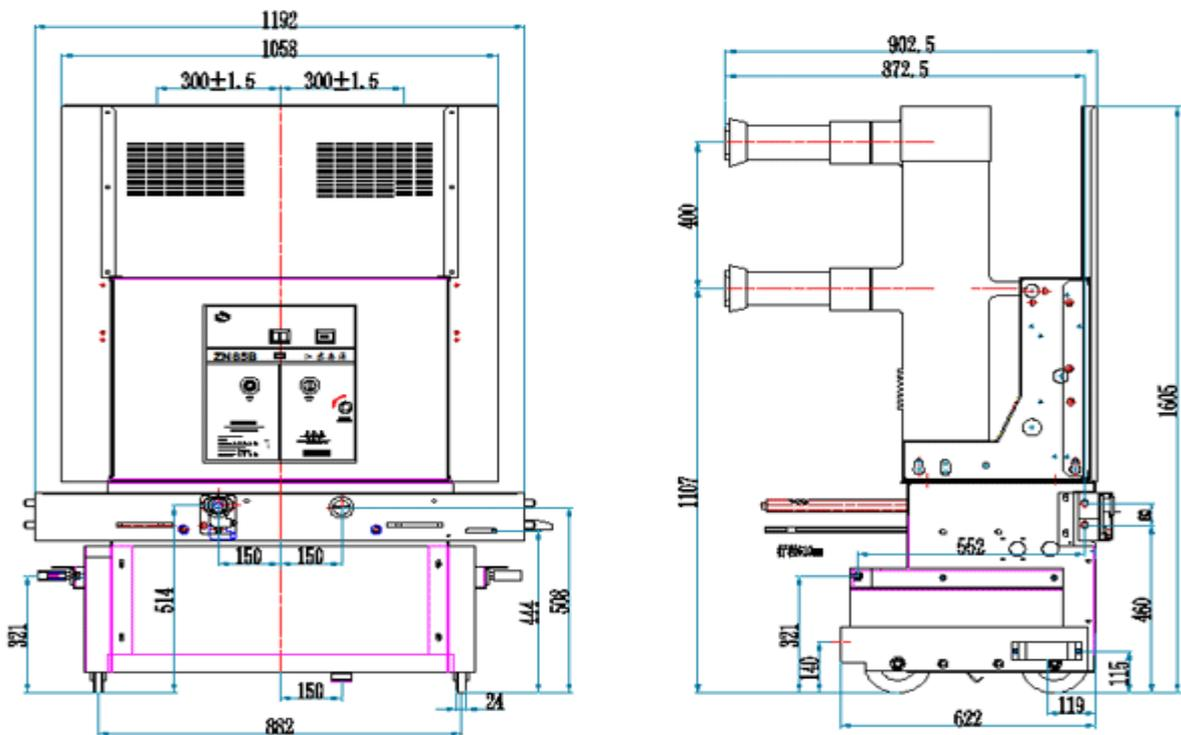
ZN85B-40.5高压真空断路器手车外形尺寸（配KYN61型开关柜）
