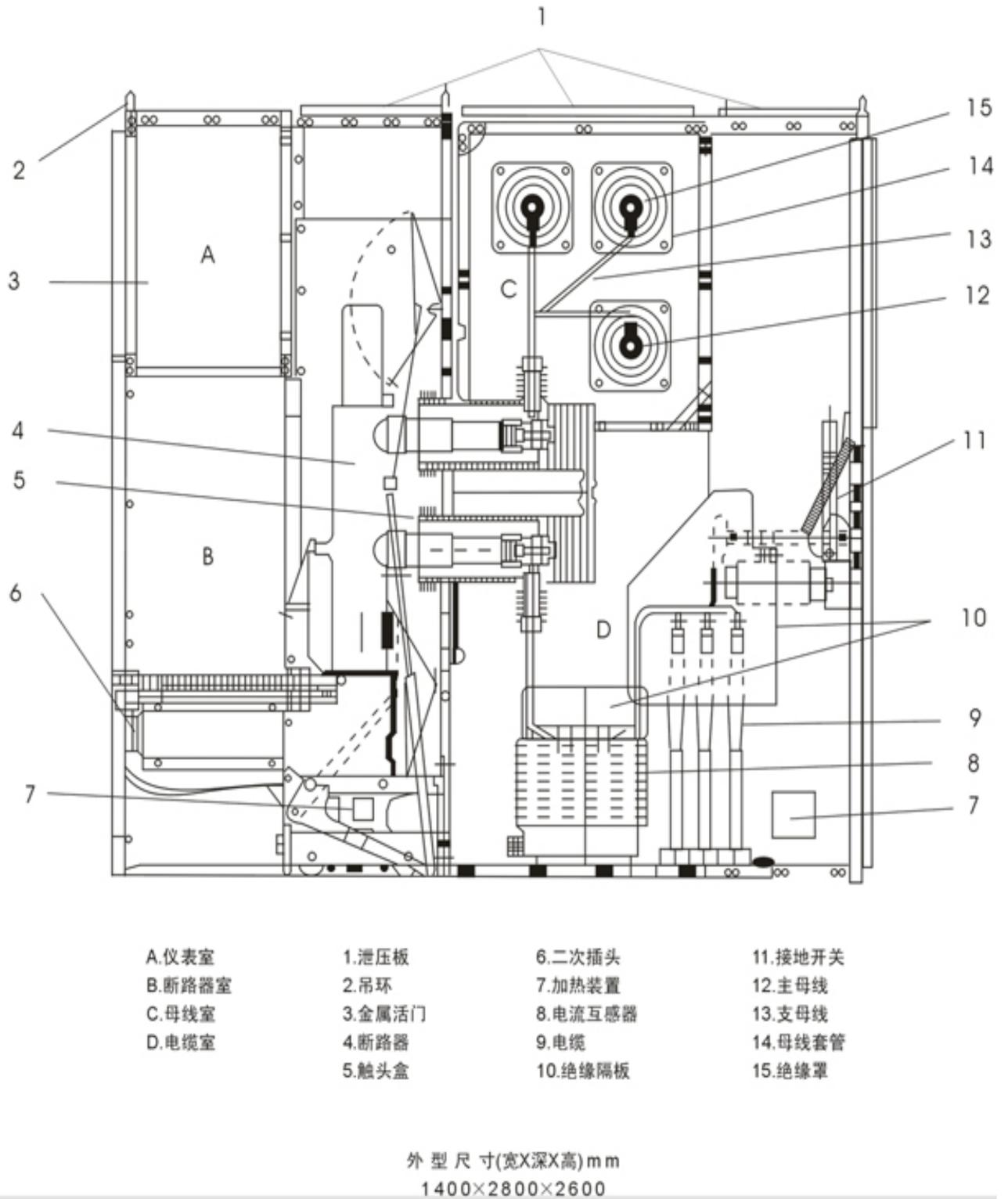
图 1. KYN61-40.5 开关柜内部结构示意图
