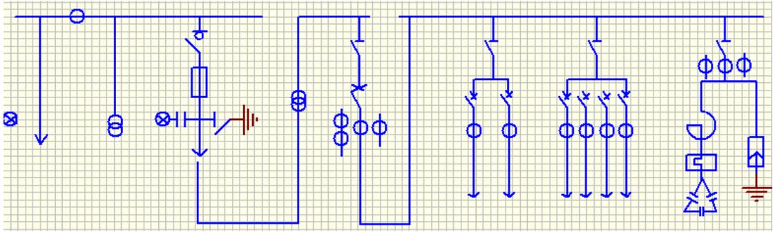
电缆进出，环网供电，低压计量，低压走廊式，低压电容补偿
