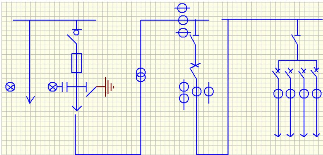
电缆进出，终端供电，高压计量，低压走廊式，低压电容补偿
